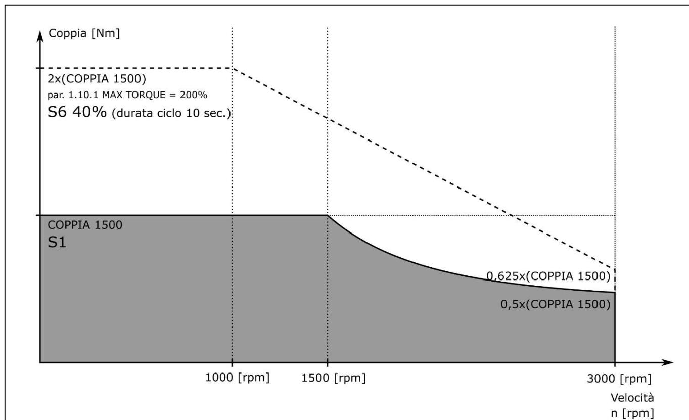
**MOTORI VETTORIALI SERIE G****DIAGRAMMI DI COPPIA 4 POLI*****Diagrammi di coppia e zone di funzionamento***
