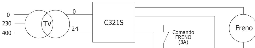
La C321S fornisce uno spunto max di 34VDC e una successiva tensione di mantenimento di 24VDC. In questo modo si velocizza lo stacco del FRENO e si evita il surriscaldamento durante il servizio continuo per periodi prolungati. Per eccitazioni ripetute, attendere almeno 1 secondo tra diseccitazione e rieccitazione del freno.
