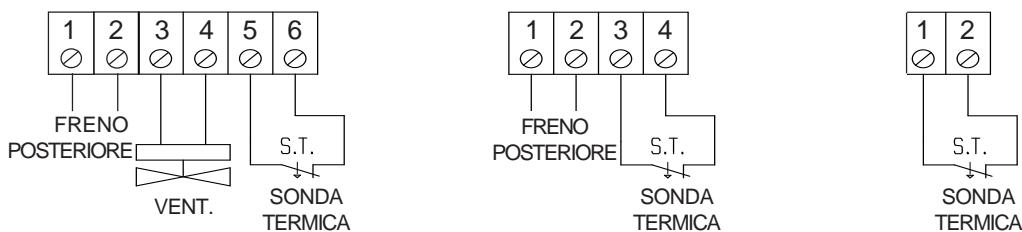
**MOTORI VETTORIALI SERIE G****COLLEGAMENTO****Collegamento del ventilatore**
