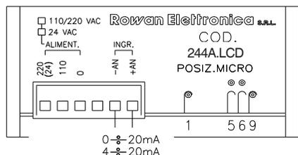
Per ingresso 4 ÷ 20mA regolare i display a zero con 4 mA di ingresso tramite il trimmer ZERO sul frontalino.
